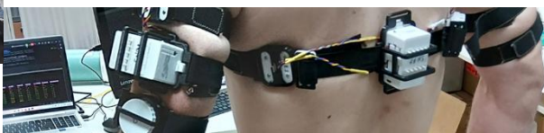
Testy systemu kalorymetrycznego - na plecach widoczny segmentowy moduł pomiarowy.
